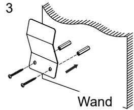
Serrez les vis dans le mur avec le support de fixation mural.
